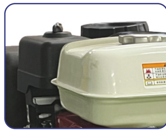
TANQUE DE COMBUSTIBLE
