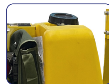
TANQUE DE COMBUSTIBLE
