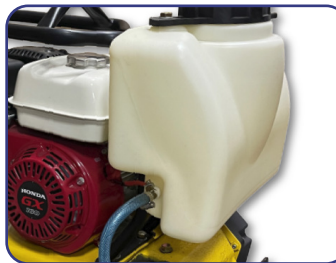
TANQUE DE AGUA
