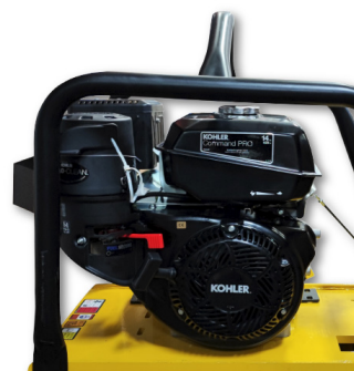
MARCO REFORZADO Mayor protector del motor
