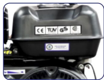
TANQUE DE COMBUSTIBLE
