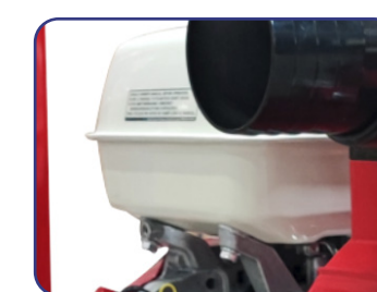
TANQUE DE COMBUSTIBLE
