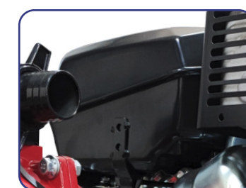
TANQUE DE COMBUSTIBLE
