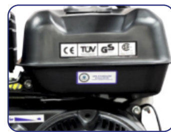
TANQUE DE COMBUSTIBLE
