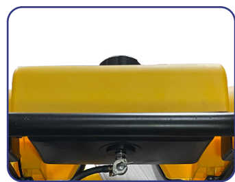
TANQUE DE COMBUSTIBLE
